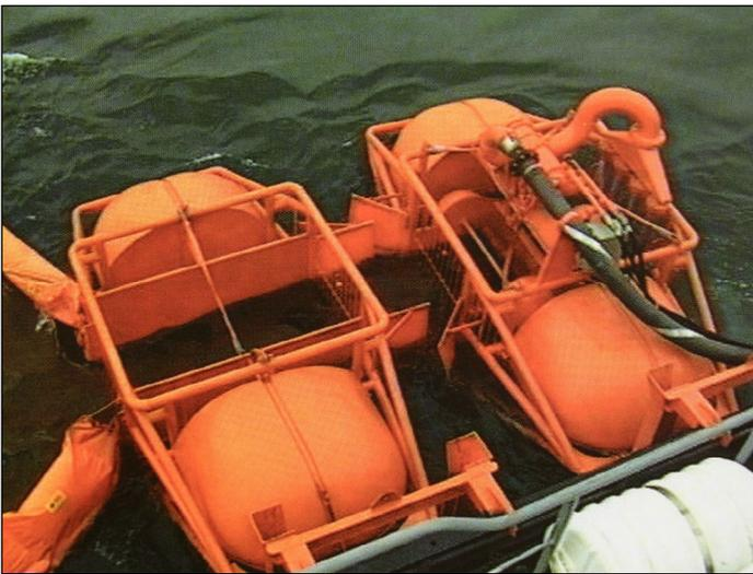
**Figura 1-Aspirador Flotante Controlado (AFC) fabricado por la empresa Novetec para la limpieza de petróleo en alta mar.**
